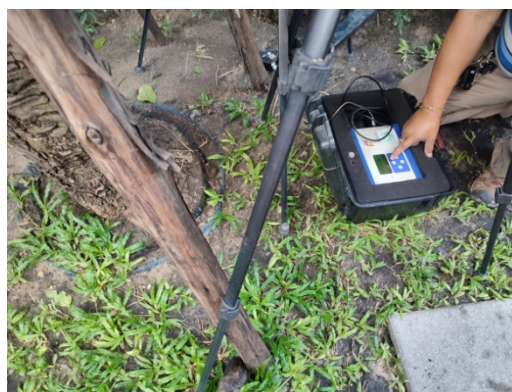
ติดตั้งเครื่องตรวจวัดฝุ่นละออง แบบ Gravimetric method เครื่องตรวจวัดเสียง ที่ อาคารชุดแอสปาย ปิ่นเกล้า อรุณอมรินทร์
